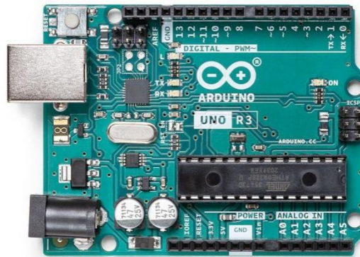
Fig 4.6 Arduino Uno Rev 3.
